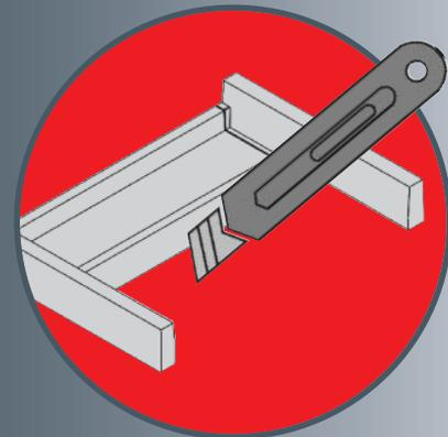
Der hintere Bereich des On Top Bio-Auszug-Deckels ist individuell kürzbar bis min. 231 mm Tiefe, z.B. für Siphon, (die Schienen bzw. Seitenteile bleiben 400 mm tief, wie gehabt).
